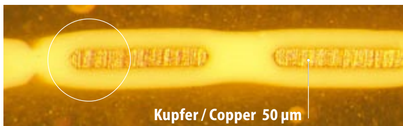
oben Bild 3: Geschnittener Flachleiter (laminiert); unten Bild 4: Gewalzter Flachleiter (extrudiert)
